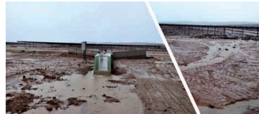
תחנת המדידה בעת אירוע גשם. ניתן לראות את הזרימה הרדודה והמשטחית מכיוון האגן. בתמונה משמאל זרימת המים ביציאה ממתקן המדידה
