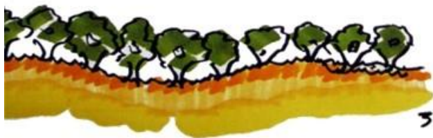
איור 5.43 סכמה להשטחת הערוצים ונטיעתם (רישום: אהרונסון) Scheme of earthwork and planting in the ravines (by Aronson)
