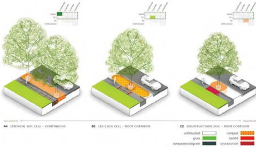
A בתי גידול לעצים. מימין לשמאל: בור שתילה לכל עץ, בור שתילה מוגדל, תעלת שתילה רציפה
